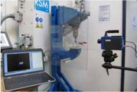
摩擦要素溶接 (FEW) の熱測定 (パッシブサーモグラフィ)。 出典: LWF
