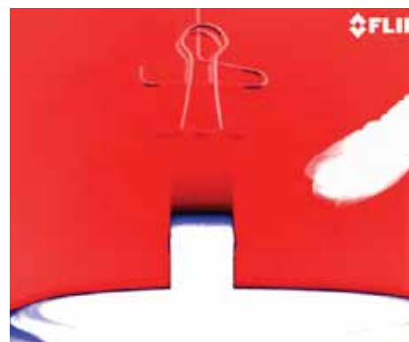
サーモグラフィで極低温液体燃料のウィッキング作用の進行状況を測定する
