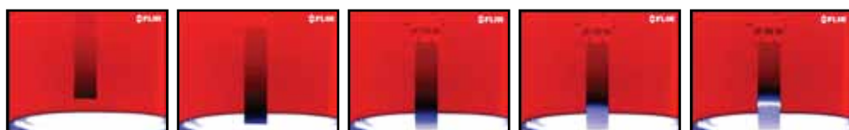
ステンレス鋼製フィルターを使用したウィッキング試験の結果を示す赤外線画像
