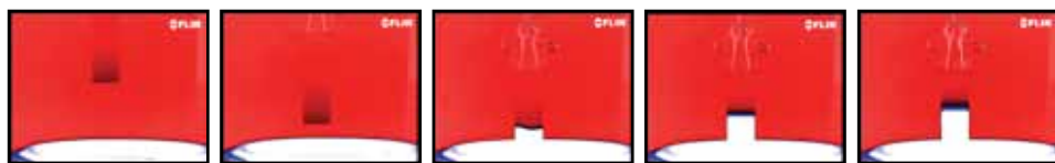
多孔質ガラスを使用したウィッキング試験の結果を示す赤外線画像
