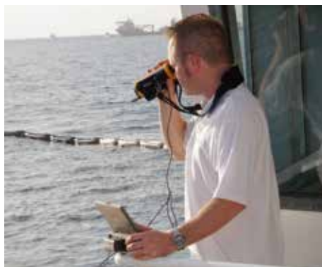
油回収作業ではハンディタイプ FLIR HMシリーズで油の位置を特定し、油回収作業者に指示した。
