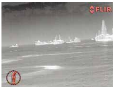
沈没したディープ・ウォーター・ホライズンから流出した油の可視画像と赤外線サーマルカメラ画像。サーマルカメラ画像では油がはっきりと確認できる。
