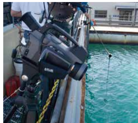
フリーステムズの赤外線サーマルカメラを使い、環境試験タンク内の漏油を様々な角度で撮影している。
