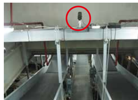
赤外線カメラFLIR A310の広角レンズは2台のコンベアベルトをモニターできる。
