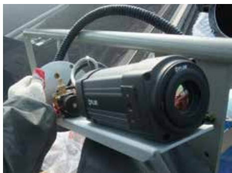
防水構造のケースに格納されコンベアベルト上に設置された赤外線カメラFLIR A310
