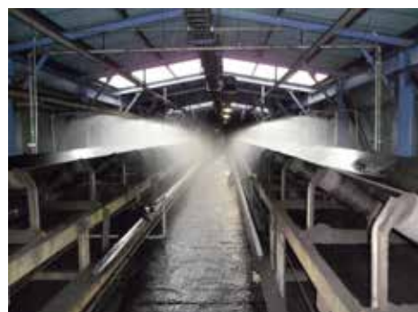
温度アラームが作動すると、PLCは直ちにコンベアベルトを停止し、スプリンクラーシステムを稼働させる。
