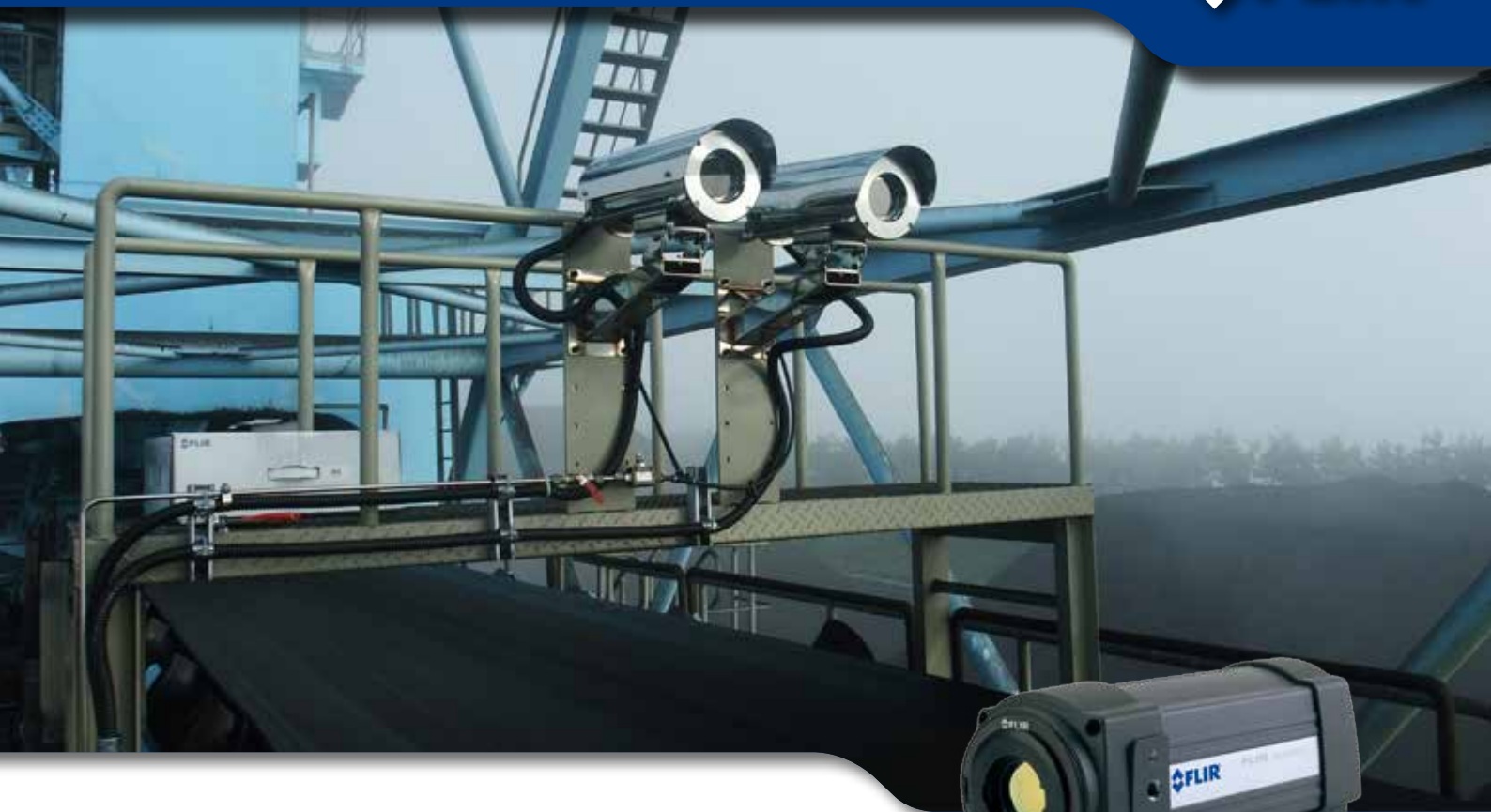
保護ケースに格納された赤外線カメラFLIR A310が石炭運搬ベルト上に設置されている。
