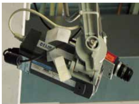
リヤガラス暖房システムの熱線の検査に使用されている赤外線カメラFLIR A320
