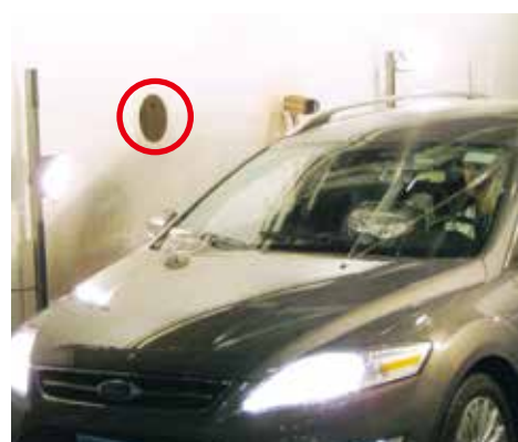
穴の後ろに設置された赤外線カメラがエアコン吹き出し口から出る空気の温度を記録する。
