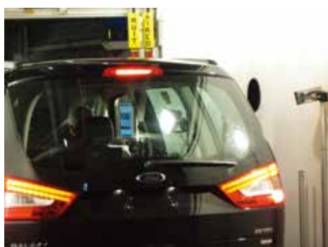
テストドライバーがリヤガラスの暖房をフルパワーでつける
