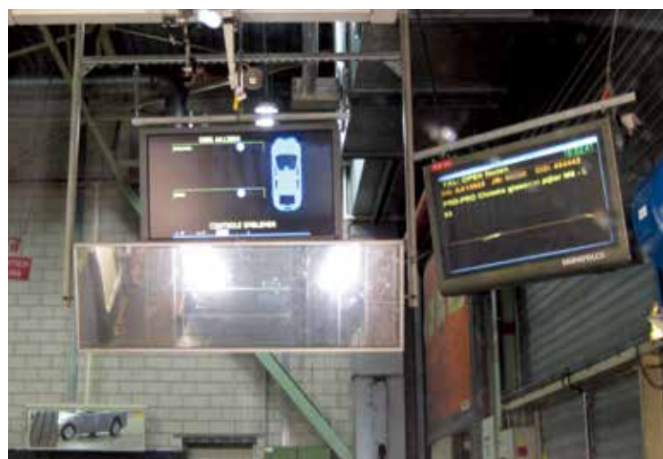
車両前方に設置された赤外線カメラFLIR A320横のスクリーンで検査の進捗状況を確認できる。
