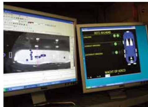
PLC(プログラム可能論理制御装置)が赤外線カメラの計測データを事前に設定したパラメータと比較する
