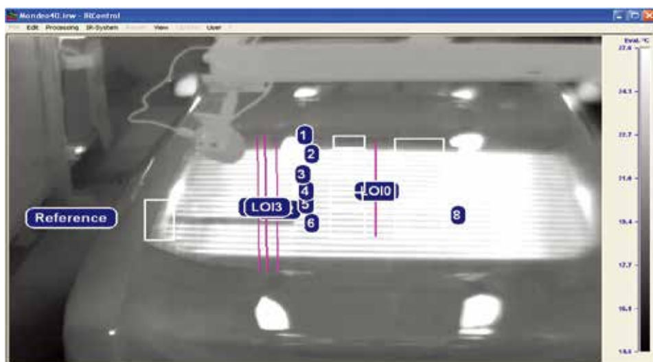
赤外線カメラFLIR A320が紫のライン上で温度を測定し、その結果をRato社がフォードゲンクに提供したソフトウェアが比較する
