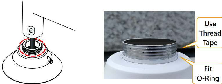
Waterproofing the Pendant Cap
