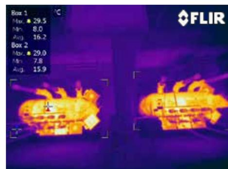
変電設備などの重要機器をFLIRA310サーマルカメラでモニタリングし、不具合の兆候である温度上昇を検出する
