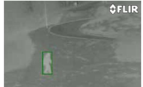
度計測のできるサーマルカメラは、解像度320×240ピクセルの熱画像を生成します。熱画像の各ピクセルで0.05℃の温度分解能で、非接触で温度計測ができるため、鮮明な熱画像の撮影ができ、微細な温度差をとらえることが可能です。内蔵のロジック、メモリ、データ通信により、画像内の温度を設定温度と比較し、データをトレンド解析とアラーム機能に付するため、モニタリングセンターに送信します。スタヴァンゲルにあるLyse Energyの発電所のサーモグラフィによる温度モニタリングシステムでは、熱画像の特定エリアが規定閾値を上回ると自動的に音声アラームが作動します。
