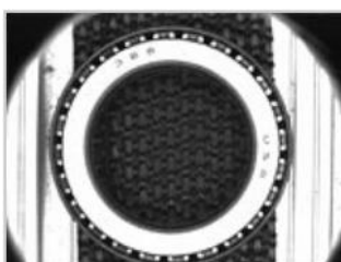
ベアリングのような部品 の特性は、カウントツ ールを用いて検証する。
