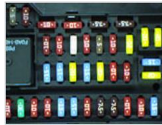
色検証ツールを用いた組立品検査
