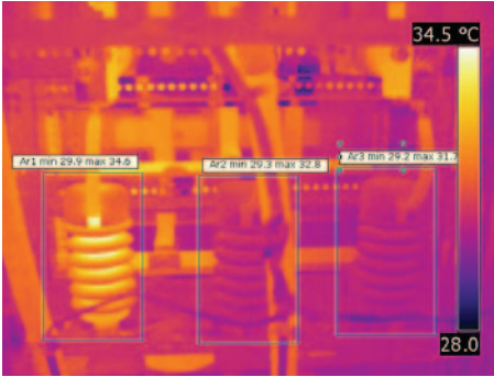
SAの異常過熱の赤外線熱画像（左）およびFLIR E60赤外線サーモグラフィで検知した実際の画像（右）
