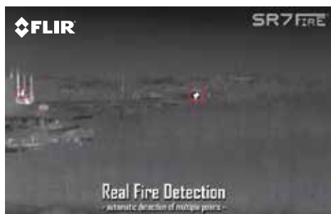
FC309モデルを使うことで、1m2の面積の温度上昇を2500m先から検出することができます。
