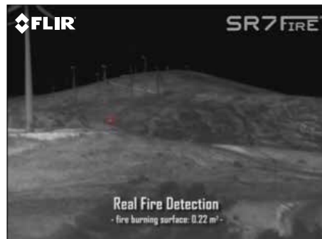
SR7のシステムでは、晴天、雨天など、あらゆる天候条件で、信頼性が高い検知結果が得られ、アラーム誤作動はほとんど起こらない。
